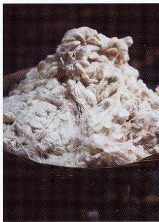
お湯に浸して柔らかくした繭を手でほぐし、優しく繰りながら1本の生糸に。太さはほんの2デニール程度。髪の毛1本=50デニールといえ、いかに細いかお判りいただけるでしょうか。
